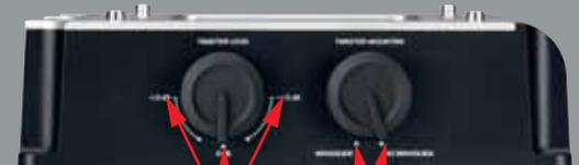
Réglage du niveau du tweeter Contour de fréquence
